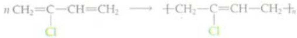
Figura 7: Policloropreno o neopreno
